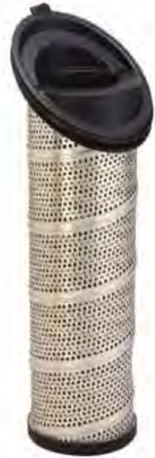
派克最新的专利Moduflow滤芯，内置集成了分流阀和旁通阀，满足各种应用场合的需要。
