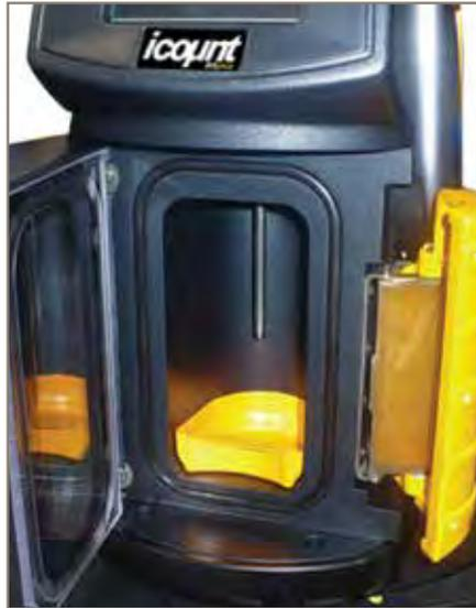
图4. 在开始测试后，IBSplus油采样探测器会自动向下进入瓶内。
