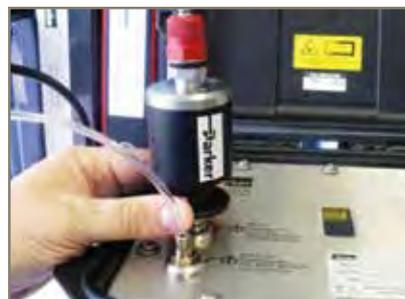
要拆除PRV时，可按下拆除工具并同时提升PRV，以便将其拆除。
