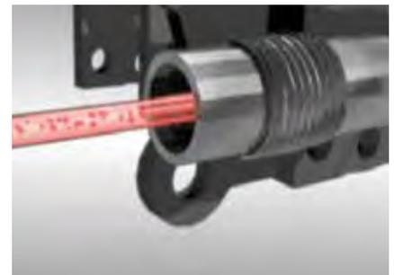
图1. 一个污染流体受控柱会进入激光光学扫描腔，该扫描腔可以确保平衡的流量和流体分布，从而保证连贯的测量结果。
