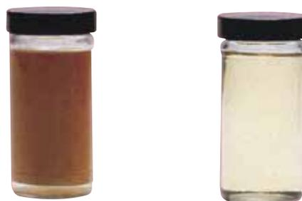
过滤前 油液图片      过滤后 油液图片
