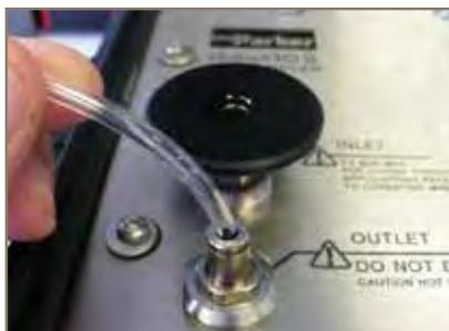
连接高压软管至OUTLET口 (Ø4mm)
