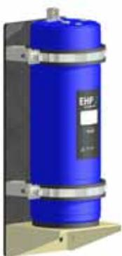
**位置：**根据应用场合的不同可以选择竖直或水平安装，竖直安装（液体端在下）最佳。如果蓄能器水平安装，请确保系统中液压介质保持清洁，不能有固体杂质。不然会导致其卡在密封圈上并磨损活塞缸内部。
