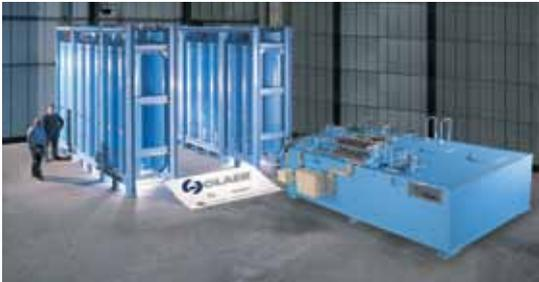
樟宜水回收厂 2003 安装的用于控制安全阀的蓄能器站。其中的氮气补充瓶配备了气液组合阀，蓄能器配备着活塞冲程极限位置感应器。
