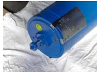
冲程或底端位置开关依靠一个护罩中的撞针来驱动。它只能垂直布置。在蓄能器气体侧底端会安装一个受压管。在其内部是一个会被活塞推动的磁性撞针。其移动可以通过全部三种指示器显示出来。
