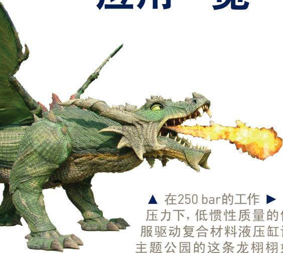
▲ 在250 bar的工作压力下，低惯性质量的伺服驱动复合材料液压缸让主题园的这条龙栩栩如生。
