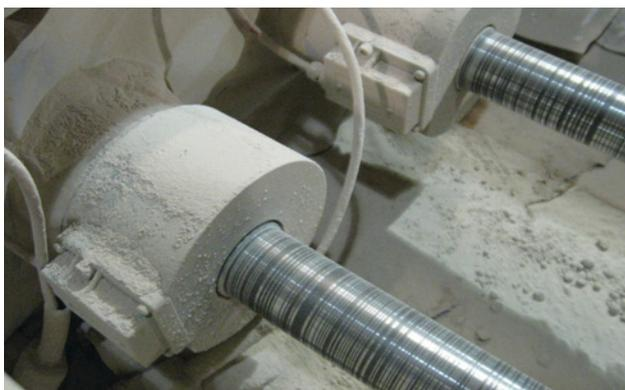
按照Arizona浮尘测试-逼真条件进行测试，没有出现任何泄漏。
