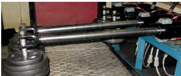
在逼真条件下，以侧向负载进行了超过100万个周期的测试，没有出现任何泄漏。
