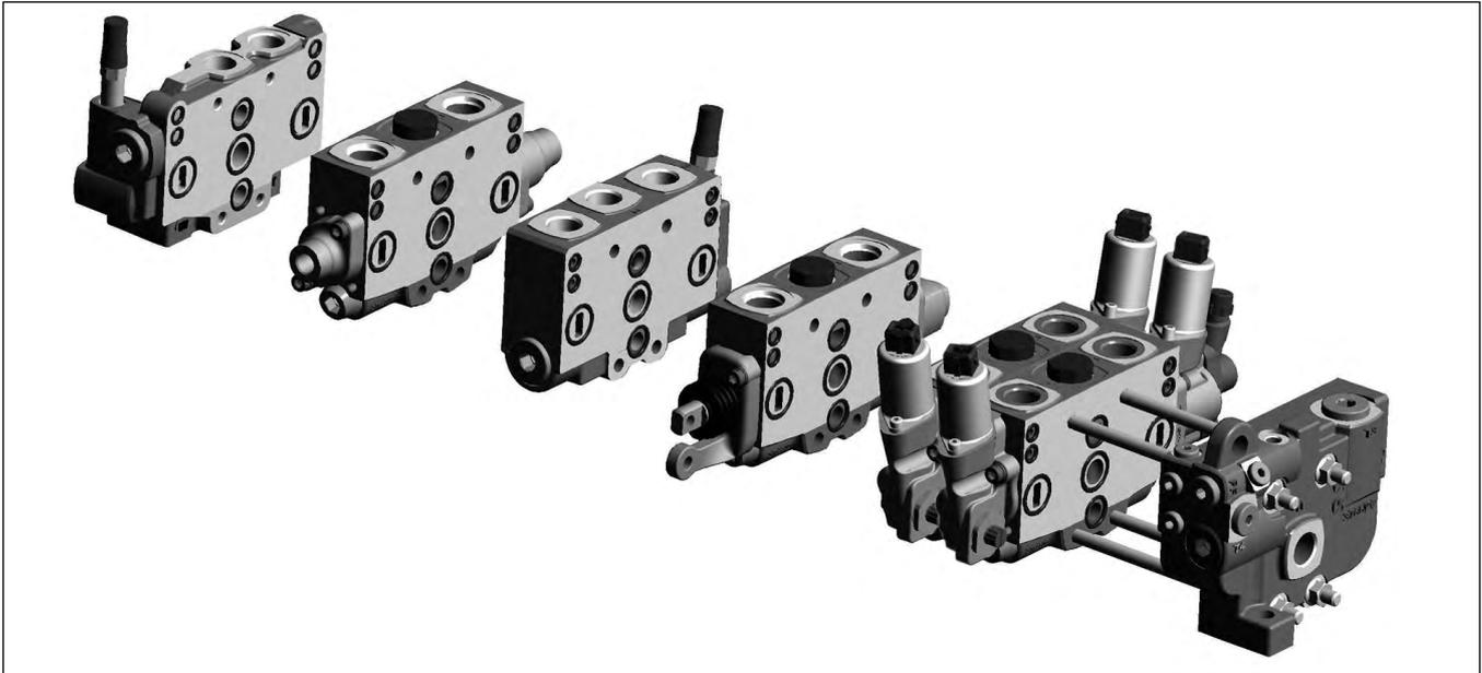
P70是一种模块化的方向控制阀，广泛应用于许多不同的场合，主要用于随车吊、小型挖掘机、小型轮式装载机和用于混凝土泵车臂架。P70有三种不同的可供货品种：**P70CF**，开中位，用于定量泵系统；**P70CP**，闭中位，用于变量泵系统；**P70LS**，闭中位，用于变量泵且带负载传感信号。
