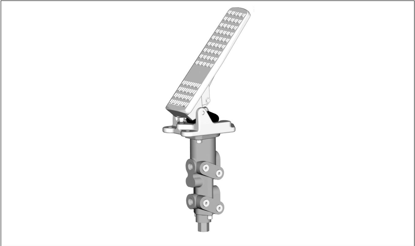
BMV通常用在液动单回路和双回路行走机械和工业液压制动系统中，这些场合都要求压力精确调节。该阀是闭中位阀，可用在开中位、闭中位和负载敏感液压系统中。阀的通流能力强，使其能和要求大流量才能制动/释放的湿式制动器一起使用。小流量阀，因其传送/释放流量制动/释放刹车的能力不足，经常受制动响应慢的困扰。无施力时Parker调节阀使湿式制动盘远远分开，因此可降低机械阻力，减少功率损耗。阀可指定设置用于安装压力开关的测压口，以及排出被困气体的排气螺钉。有多种驱动力可指定，包括阶段调节弹簧，可增加踏板触感。或者，有一个提高液压响应的选项，可实现自然的踏板效果。
